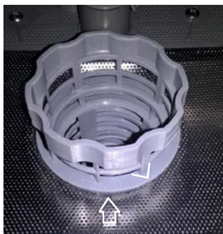
špatně zajištěný filtr
