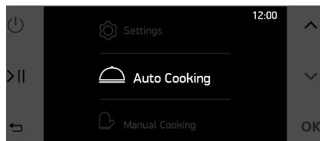
I den automatisk tilberedningsmenu kan kategori, navn og vægten for opskriften vælges af slutbrugeren. Også sluttiden for tilberedningen kan ændres af slutbrugeren. Bladr med op- og ned-knapperne for at ændre en specifikation, og vælg specifikationen med OK-knappen. Den valgte specifikation blinker, når du har trykket. Mens den blinker, kan op- og ned-knapperne bruges til at ændre specifikationens værdi. Du afslutter valget ved at trykke på OK-knappen.
