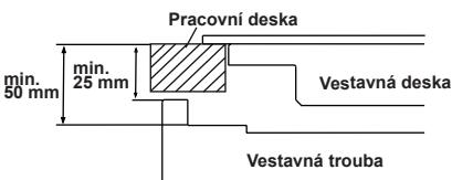
Je-li trouba nainstalovaná pod plotnou, vzdálenost mezi pracovní plochou a horním panelem trouby musí být minimálně 50 mm a vzdálenost mezi pracovní plochou a horní částí ovládacího panelu musí být minimálně 25 mm.
