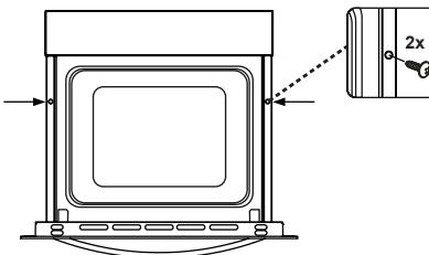
Troubu zasuňte do skříně. Otevřete dveře trouby a do otvorů v rámu trouby zasuňte 2 šrouby. Zatímco se rám produktu dotýká dřevěného povrchu skříně, šrouby utáhněte.
