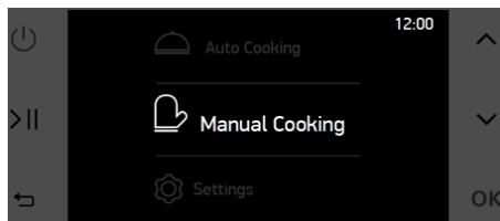
V menu manuálního vaření může koncový uživatel vybrat funkce vaření, délku trvání a čas ukončení vaření. Chcete-li změnit některé specifikace, možnostmi procházejte pomocí tlačítek NAHORU a DOLŮ a výběr potvrďte tlačítkem OK. Po klepnutí se vybraná specifikace rozbalí. Během blikání se ke změně hodnoty specifikace použijí tlačítka NAHORU a DOLŮ. Výběr můžete dokončit klepnutím na tlačítko OK.
