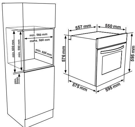
Hvis ovnen installeres under en kogeplade, skal afstanden mellem bordplade og toppanelet på ovnen være mindst 50 mm, og afstanden mellem bordpladen og toppen af betjeningspanelet skal minimum være 25 mm.
