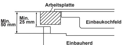
Wenn der Backofen unter einem Kochfeld eingebaut wird, dann muss der Abstand zwischen der Arbeitsplatte und der oberen Platte des Backofens mindestens 50 mm und der Abstand zwischen der Arbeitsplatte und der oberen Kante der Steuertafel mindestens 25 mm betragen.
