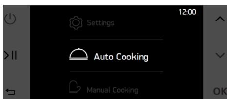
V menu automatického vaření koncový uživatel vyberte kategorii, název receptu a hmotnost. Koncový uživatel může změnit čas ukončení vaření. Chcete-li změnit některé specifikace, možnostmi procházejte pomocí tlačítek NAHORU a DOLŮ a výběr potvrďte tlačítkem OK. Po klepnutí se vybraná specifikace rozbalí. Během blikání se ke změně hodnoty specifikace použijí tlačítka NAHORU a DOLŮ. Výběr můžete dokončit klepnutím na tlačítko OK.
