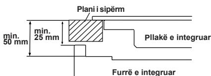
Nëse furra instalohet nën një pllakë, distanca mes platformës së punës dhe panelit kryesor të furrës duhet të jetë minimalisht 50 mm dhe distanca mes platformës së punës dhe paneli kryesor të kontrollit duhet të jetë minimalisht 25 mm.
