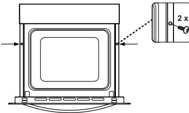
Schieben Sie den Backofen vorwärts in den Schrank. Öffnen Sie die Backofentür und setzen die beiden Schrauben in die Löcher im Rahmen des Ofens. Wenn der Rahmen des Backofens die Holzoberfläche des Schranks berührt, ziehen Sie die Schrauben fest.
