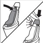
**3** Vložte strojek do držáku, nakloňte strojek směrem vzad a zatlačením na horní kryt holicí strojek připojte (ozve se cvaknutí).
