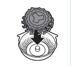
**6** Po očištění vložte stříhací jednotku zpět do krytu.
