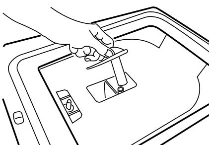
3. Při vrácení zásobníku na místo umístěte jazýčky na spodní části zásobníku do příslušných otvorů na víku a zatlačte zásobník proti víku, dokud nezavakne na místo.
