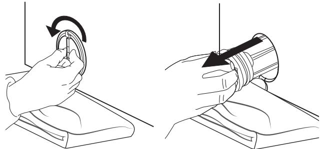
5. Vodní filtr vyčistěte: odstraňte usazeniny z vodního filtru pod tekoucí vodou.
