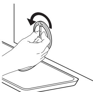
4. Vyjměte filtr: Pod vodní filtr položte bavlněný hadík, který nasákne menší množství zbytkové vody. Následně otáčením proti směru chodu hodinových ručiček vodní filtr vyjměte.
