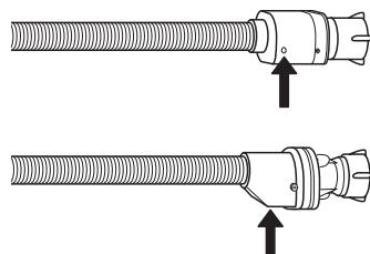
Hadice s automatickým systémem zastavování přívodu vody: zkонтrolujte malé inspekční okénko na bezpečnostním ventilu (viz šipka). Je-li červené, byla aktivována funkce bezpečnostního uzavření a hadici je třeba vyměnit za novou. Chcete-li tuto hadici odšroubovat, stiskněte přitom uvolňovací tlačítko (je-li jím vybavena).
