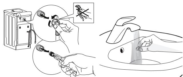
4. Vložte sítkový filtr zpět na své místo. Připojte hadici k pračce i k přívodu vody. Při našroubování hadice nepoužívejte žádné nástroje. Otevřete přívod vody a zkонтrolujte, že všude těsní.
