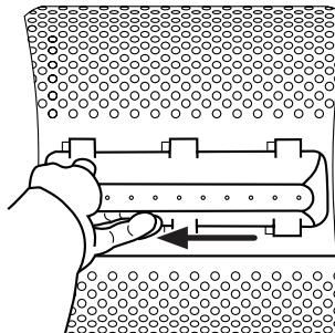
6. Zavřete dvírka bubnu, otočte jím o půl otáčky a zkонтrolujte umístění žebra a jeho kotvíčích bodů.
