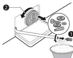
**4** Po vyčištění filtru odtokového čerpadla sejměte filtr odtokového čerpadla a vložte odtokovou zátku.
