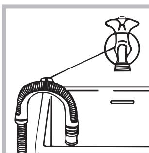
illetve akassza a mosdó vagy a kád szélére úgy, hogy a mellékelt csővezető ívet a csaphoz erősíti (lásd ábra). A leeresztőcső szabad végének nem szabad vízbe merülnie.
