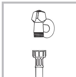
1. A vízbevezető cső csatlakoztatásához csavarozza fel a csövet egy 3/4"-os külső menettel rendelkező hidegvíz csapra (lásd ábra). A csatlakoztatás előtt erezze meg a csapot addig, amíg a víz teljesen átlátszóvá nem válik.
