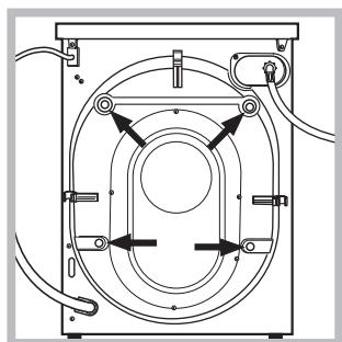
3. Odstraňte 4 šrouby chránící před poškozením během přepravy a gumovou podložku s příslušnou rozpěrkou, které nachází v zadní části (viz obrázek).
