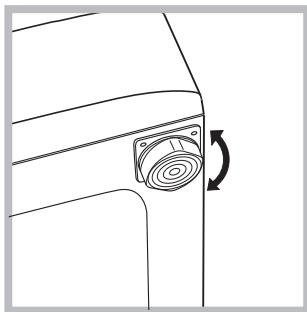
2. Si el piso no está perfectamente horizontal, compense las irregularidades desenroscando o enroscando las patas delanteras (ver *la figura*); el ángulo de inclinación medido sobre la superficie de trabajo, no debe superar los 2°. Una cuidadosa nivelación
