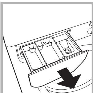
Extraiga el contenedor levantándolo y tirándolo hacia fuera (*ver la figura*). Lávolo debajo del agua corriente, esta limpieza se debe realizar frecuentemente.
