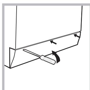
1. αφαιρέστε το ταμπλό κάλυψης στο πρόσθιο πλευρό του πλυντηρίου με τη βοήθεια ενός κατσαβιδιού (βλέπε εικόνα).
