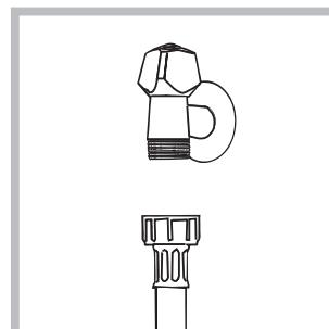
1. Conectar el tubo de tubo enroscándolo a un grifo de agua fría con la boca rosizada de 3/4 gas (*ver la figura*). Antes de conectarlo, haga correr el agua hasta que esté limpia.
