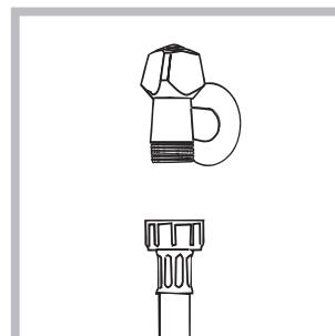
1. Συνδέστε το σωλήνα τροφοδοσίας βιδώνοντάς τον σε ένα κρουνό κρύου νερού με στόμιο σπειρώματος 3/4 gas (βλέπε εικόνα). Πριν τη σύνδεση, αφήστε να τρέξει το νερό μέχρι να γίνει διαυγές.
