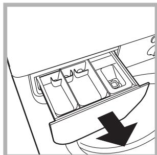
A fiók felemelésével és kifelé húzásával vegye ki a fiókot (*lásd ábra*). Folyó víz alatt mosza ki! Ezt a tisztítást gyakran kell végezni.
