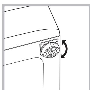
2. Jeśli podłoga nie jest idealnie pozioma, należy skompensować nierówności, odkręcając lub dokręcając przednie nóżki (patrz rysunek); kąt nachylenia, zmierzony na górnym blacie pralki nie powinien przekraczać 2°.
