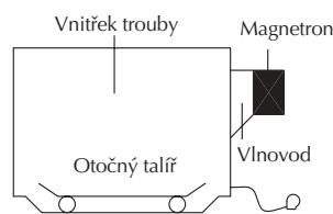
V mikrovlnné troubě je energie přeměněna na mikrovlny pomocí MAGNETRONU
