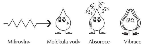
Mikrovlny způsobují vibraci molekul vody, která následně způsobuje TŘENÍ, tzn. TEPLO. Toto teplo pak ohřívá potraviny. Mikrovlny také působí na tuky a cukry, a proto se potraviny s vyšším obsahem tuku a cukru ohřejí rychleji. Mikrovlnou mohou prostoupit pouze hloubkou 4-5 cm. Jak teplo prostupuje potravinou, stejně jako u tradiční trouby, potravina se ohřívá z vnějšku dovnitř.
