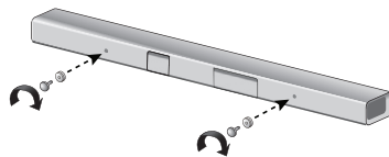
Upevnění přístroje Soundbar na stěnu
