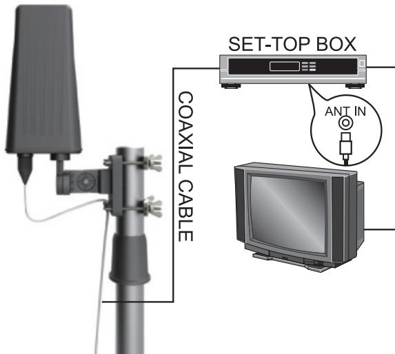
Podłączyć kabel sygnałowy z anteny do odbiornika cyfrowego, ustawić w odbiorniku zasilanie anteny a następnie połączyć odbiornik cyfrowy z telewizorem.
