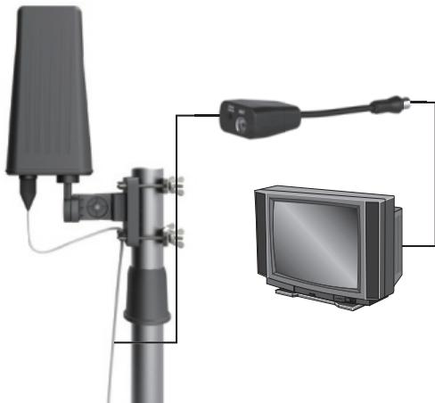
Csatlakoztassa az antenna kábelét a megfelelő aljzatba, utána dugja be a kimeneti konnektort a TV-be, majd dugja be a tápkábelt az elektromos konnektorba.
