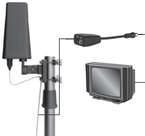
Podłączyć kabel sygnałowy z anteny do wejścia sygnałowego w zasilaczu, podłączyć wyjście zasilacza do telewizora. Podłączyć zasilacz do źródła zasilania.
