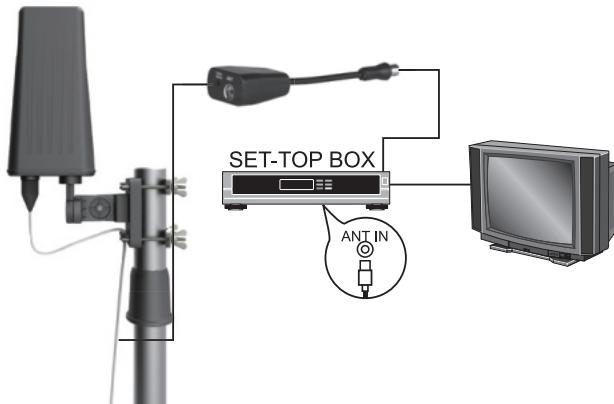
Podłączyć kabel sygnałowy z anteny do wejścia sygnałowego w zasilaczu, podłączyć wyjście zasilacza do odbiornika cyfrowego. Podłączyć zasilacz do źródła zasilania a na końcu połączyć odbiornik cyfrowy z telewizorem.
