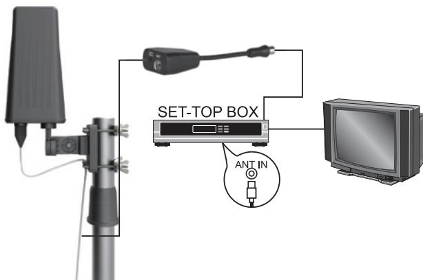
Připojte signálový kabel z antény ke vstupnímu konektoru signálu napájení, připojte výstupní konektor napájení k digitálnímu přijímači, zapojte napájecí adaptér do napájení a zapojte do zásuvky, a nakonec připojte televizor a digitální přijímač.
