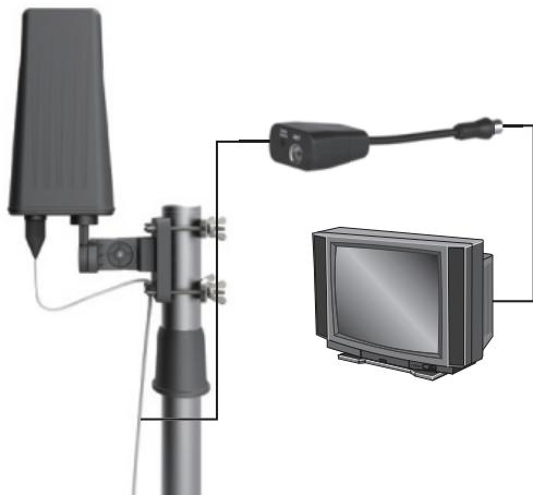
Pripojte signálový kábel z antény ku vstupnému konektoru signálu napájania, pripojte výstupný konektor napájania k televízoru, zapojte napájací adaptér do napájanie a zapojte do zásuvky.
