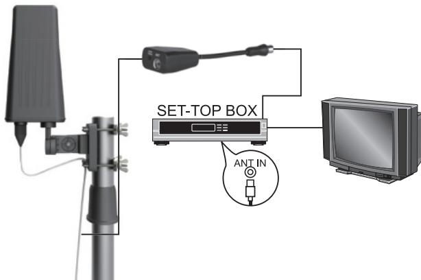
Csatlakoztassa az antenna kábelét a megfelelő aljzatba, utána dugja be a kimeneti konnektort a digitális vevő készülékbe, dugja be a tápkábelt az elektromos konnektorba, majd a végén csatlakoztassa a digitális vevő készüléket és a TV-t.
