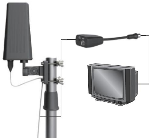
Připojte signálový kabel z antény ke vstupnímu konektoru signálu napájení, připojte výstupní konektor napájení k televizoru, zapojte napájecí adaptér do napájení a zapojte do zásuvky.
