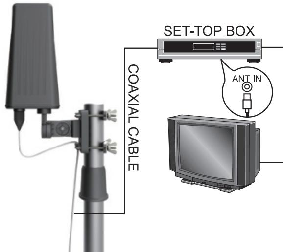
Připojte signálový kabel z antény k digitálnímu přijímači, nastavte přijímač tak, aby dodával proud do antény a připojte televizor a digitální přijímač.
