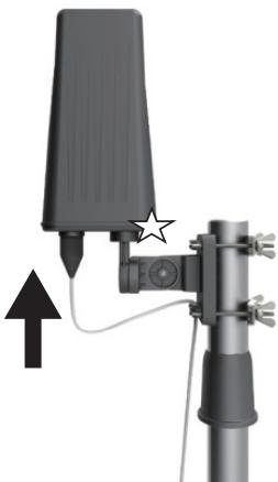
Przymocować nakładkę wodoszczelną przykrywającą połączenie, tak żeby uniknąć przesączania się wody.
