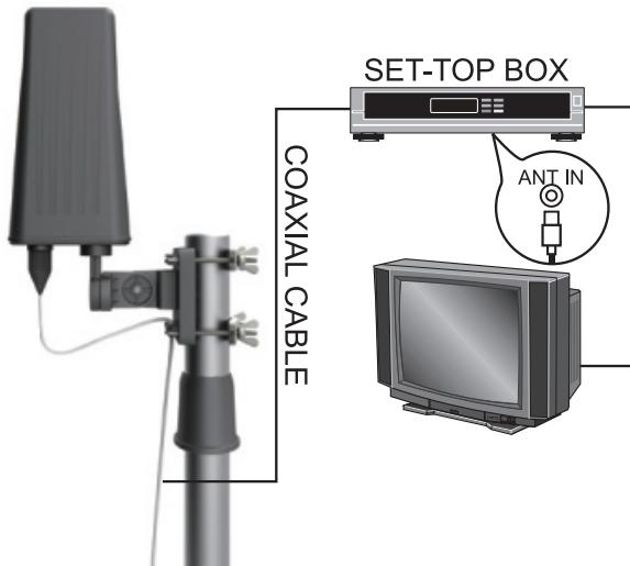
Csatlakoztassa az antenna kábelét a digitális vevő készülékhez, állítsa be a digitális vevőt a tápellátási funkcióba, utána csatlakoztassa a TV-t.
