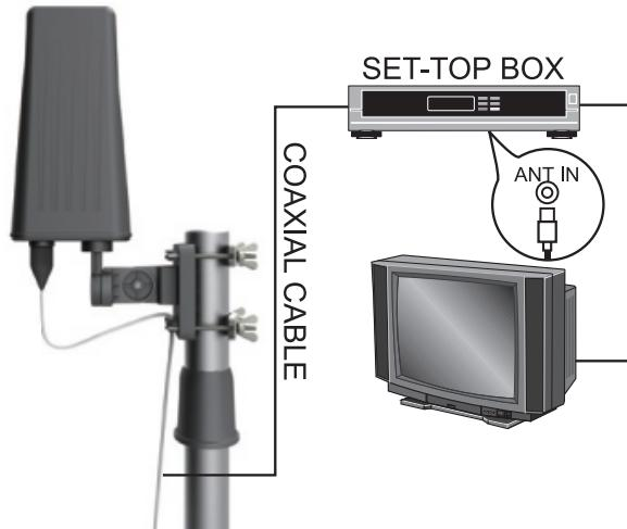
Pripojte signálový kábel z antény k digitálnemu prijímaču, nastavte prijímač tak, aby dodával prúd do antény a pripojte televízor a digitálny prijímač.
