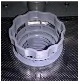
špatně zajištěný filtr
