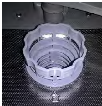
správně zajištěný filtr
