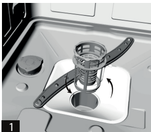
Krok 1: Otočte filtrom proti smeru chodu hodinových ručičiek a potom ho vysuňte.
