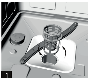
Korak 1: Okrenite filter u suprotnom smeru od kretanja kazaljki na satu i zatim ga izvadite.
