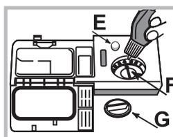
1. Otevřete nádobku otáčením uzávěru „G“ proti směru hodinových ručiček.
