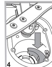
Po vyčištění filtrů proveďte zpětnou montáž filtrační jednotky a její správné umístění do jejího uložení; představuje nezbytný předpoklad správné činnosti myčky.
