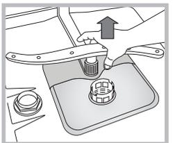
Demontáž spodního ostřikovacího ramena se provádí stisknutím jazýčků, nacházejících se po stranách, směrem nahoru.
