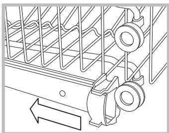
Otevřete pojistky vodicích drážek koše na pravé i na levé straně a vytáhněte koš; umístěte jej do horní nebo spodní polohy a zasunujte jej podél vodicích drážek, dokud se do drážky nedostanou i přední kolečka, a poté zajistěte pojistky (viz obrázek).
