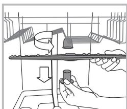
Demontáž horního ostřikovacího ramena vyžaduje odšroubování plastové kruhové matice proti směru hodinových ručiček. Horní ostřikovací rameno je třeba namontovat tak, aby bylo obráceno otvory směrem nahoru.
