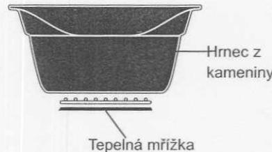
**POZNÁMKA:** Při pokládání hrnce z kameniny na povrch keramické či hladké skleněné varné desky, pracovní desky či stolu dbejte zvýšené opatrnosti. Kvůli charakteristické vlastnosti kameniny - drsné spodní části - by jinak mohlo dojít k poškrábání těchto povrchů.
