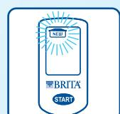
Blinkt das leere FilterkartuschenSymbol mit „NEW“, so müssen Sie jetzt Ihre MAXTRA Filterkartusche wechseln.
