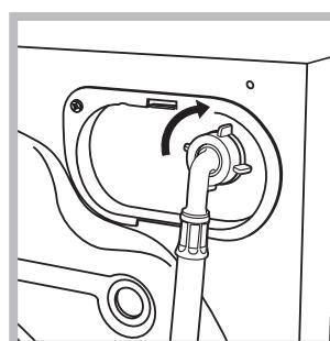
2. A vízbevezető cső csatlakoztatásához csavarozza a csövet a mosógép hátoldalán jobbra fent található vízbemeneti csonakra (lásd ábra)!
