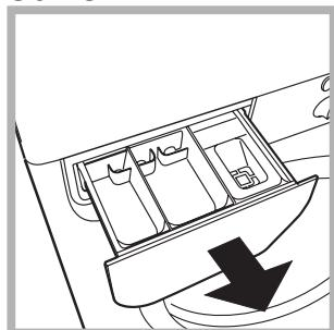
Vytiahnite dávkovač jeho nadvhnutím a vytiahnutím smerom von (*vid' obrázok*). Dávkovač umyte pod prúdom vody; toto čistenie je potrebné vykonávať pravidelne.
