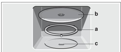
**Upozornenie:** Spotrebič používajte len s nasadeným otočným tanierom. Dávajte pozor na to, aby otočný tanier správne zapadol. Otočný tanier sa môže otáčať dočasne alebo doprava.
