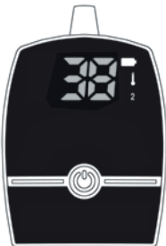
Die für das Sendegerät Nr. 2 eingestellte Maximaltemperatur wurde überschritten.
