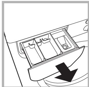
Vytiahnite dávkovač jeho nadvihnutím a vytiahnutím smerom von (*viď obrázok*). Dávkovač umyte pod prúdom vody; toto čistenie je potrebné vykonávať pravidelne.
