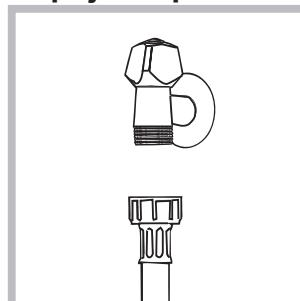
1. Pripojte prívodnú hadicu jej zaskrutkovaním ku kohútiku so studenou vodou s hrndlom so závitom 3/4" (viď obrázok). Pred pripojením hadice nechajte vodu odtieť, až kým nebudete círa.
