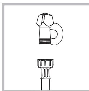
1. Schrauben Sie den Wasserschlauch an einen Kaltwasserhahn mit  $\frac{3}{4}$ -GAS-Gewindeanschluss an (siehe Abb.). Lassen Sie das Wasser vor dem Anschluss so lange auslaufen, bis klares Wasser austritt.
