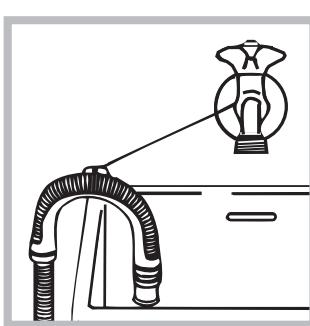
Befestigen Sie diesen mittels des mitgelieferten Schlauchhalters z.B. an einen Wasserhahn (siehe Abbildung). Das freie Ablaufschlauchende darf nicht unter Wasser positioniert werden.
